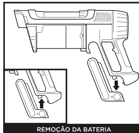
REMOÇÃO DA BATERIA
